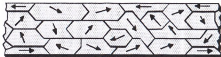
FIGURE 1 – Schéma d'un matériau ferromagnétique possédant des domaines de Weiss
