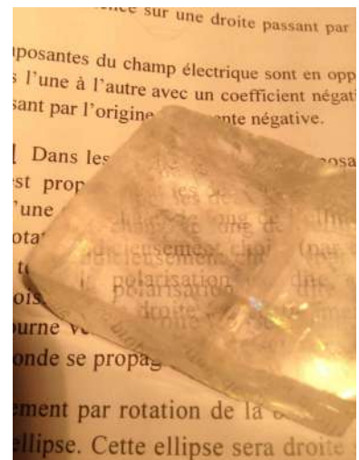
FIGURE 6.1 – Cristal biréfringent placé devant un objet (un texte). On observe deux rayons sortant avec des directions distinctes. C'est une propriété caractéristique de la biréfringence.
