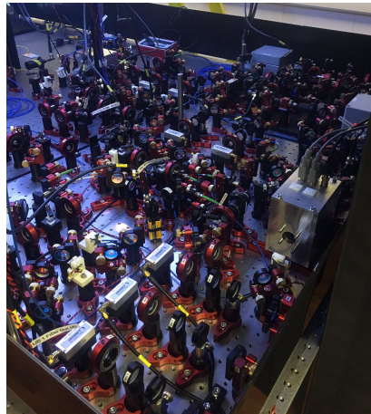
FIGURE 2 – Exemple d'un montage d'optique dédié à l'étude des atomes froids. Image tirée du compte Twitter de l'équipe MBQD à Cambridge.
