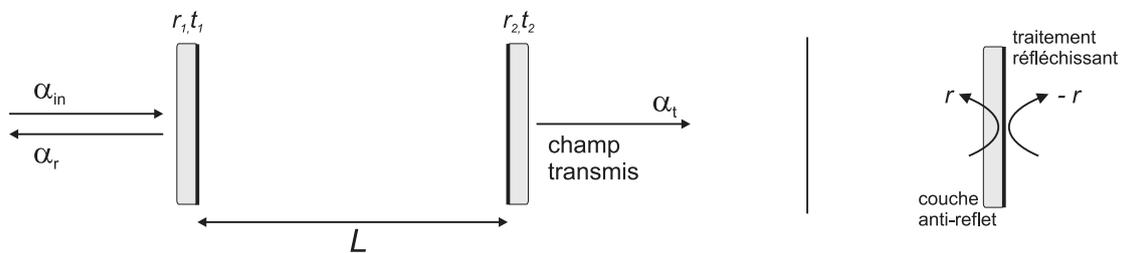
FIGURE 1 – Gauche : Notations pour le calcul des champs. Droite : Valeurs des coefficients de réflexion d'un miroir pour deux ondes incidentes de deux côtés différents.
