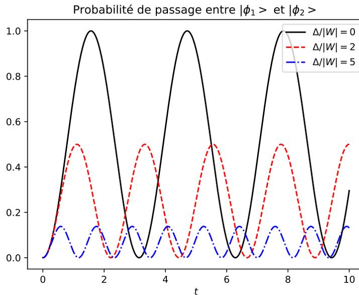
Sur le graphique ci-dessus, on remarque que la fréquence de transition augmente si le désaccord  $\Delta$  augmente. Cependant, le maximum de la probabilité diminue lorsque  $\Delta$  s'éloigne de 0. On en déduit donc que le couplage le plus fort a lieu pour des niveaux d'énergie égaux.
