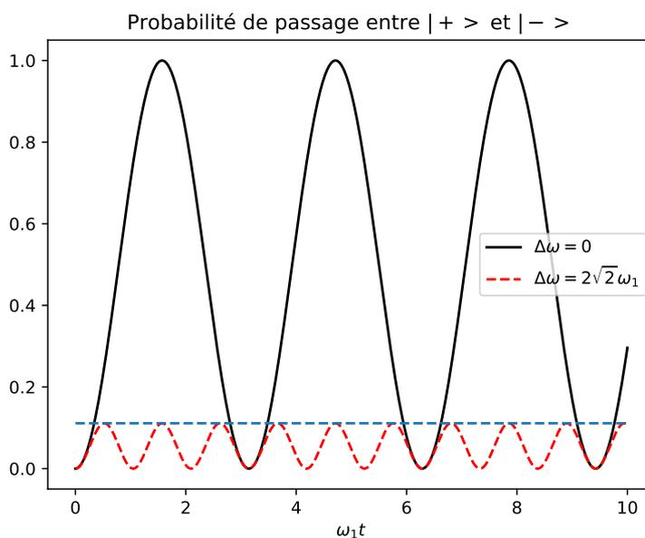
La « résonance » est obtenue pour  $\Delta\omega = 0$ , c'est lorsque la probabilité de passage dans l'état  $|-\rangle$  est maximale. Si on trace cette probabilité maximale en fonction de  $\Delta\omega$ , on retrouve une courbe typique de résonance.
